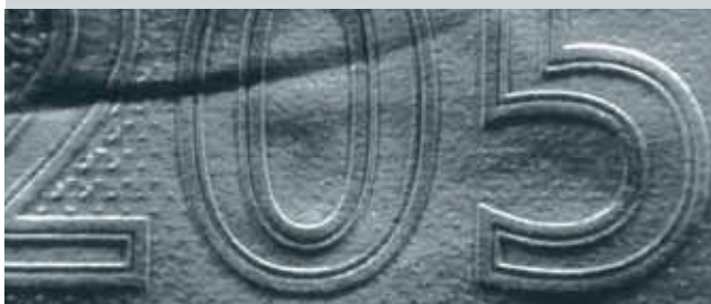
Analiza druku wklęsłego w absorpcji IR
