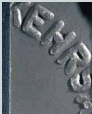
■ Badanie druku wklęsłego z użyciem światła bocznego
