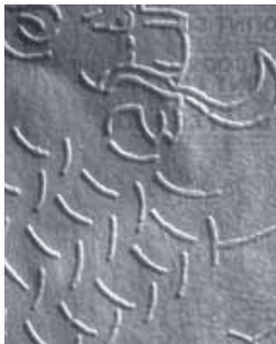
Druk wklęsły widoczny w bocznym świetle IR
