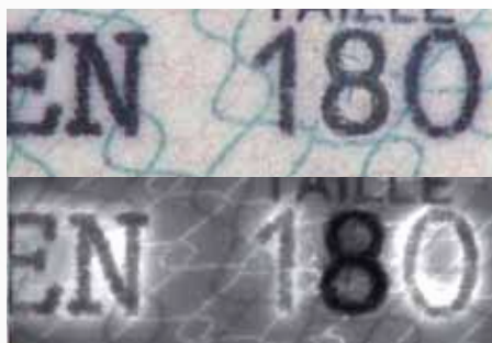
Badanie z użyciem luminescencji IR w celu rozróżnienia tuszów drukarskich
