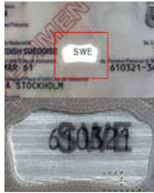
MLI Wizualizacja multilaserowa obrazu w świetle bocznym
