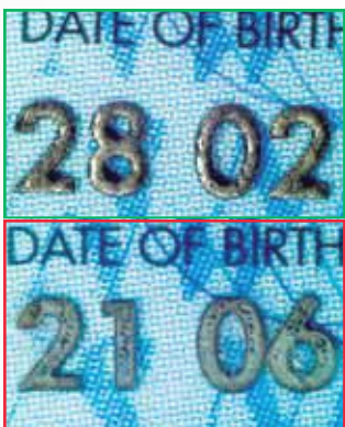
Grawerowanie laserowe; oryginał i falsyfikat w świetle bocznym
