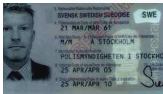
Badanie znaków bezpieczeństwa ImagePerf/TLI® w świetle przechodzącym
